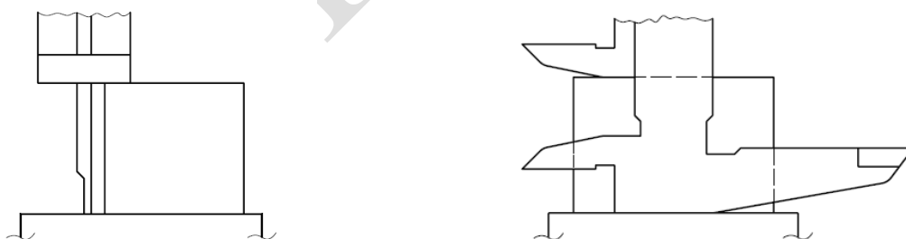
Obr. č. 7 Příklad stanovení posunuté chyby hloubkoměru a měřidla schodů
