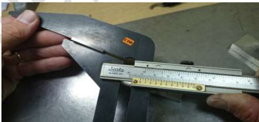
Obrázek č. 3 – Posuvného měřidla s indexem (chybějící noniusová stupnice „palcová“ omezuje použití pouze pro metrickou část)
