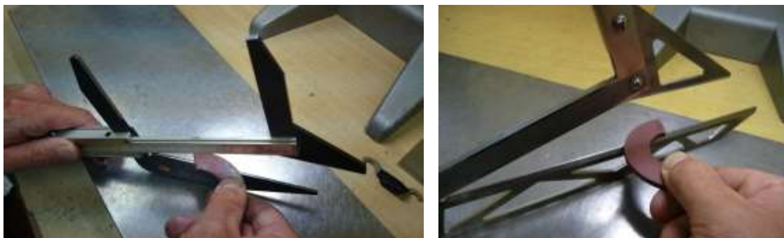
Obrázek č. 4 a č. 5 – Oprava pomocných ramen a čelistí posuvných měřidel s indexem
