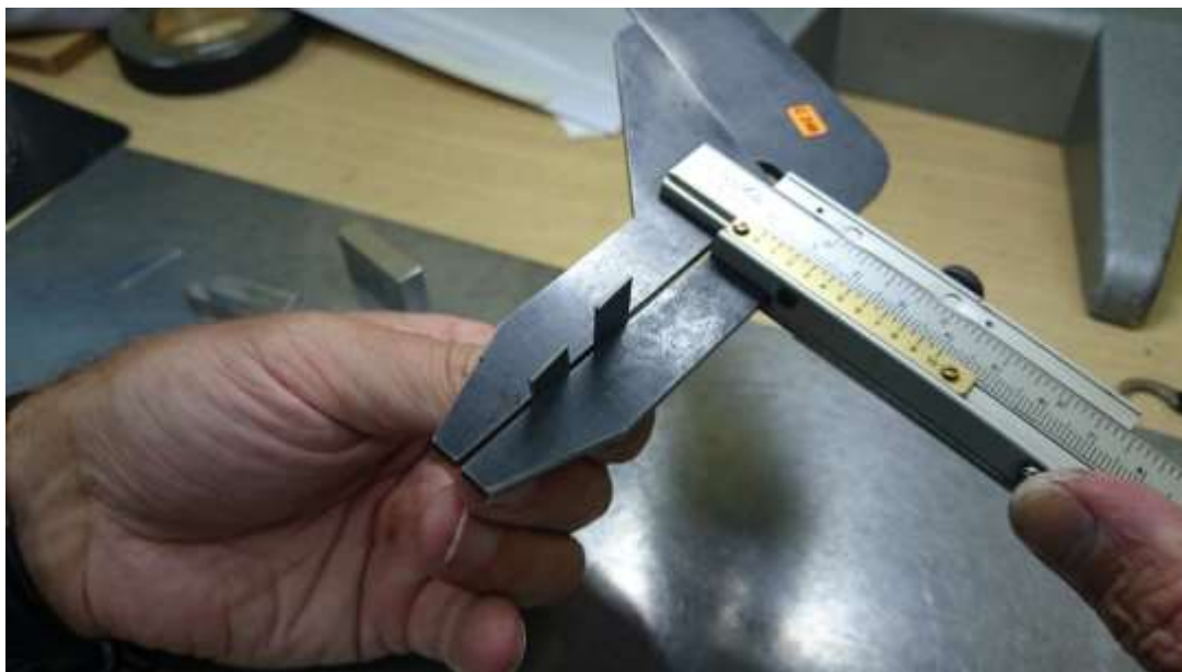
Obrázek č. 6 – Měření rovnoběžnosti čelistí posuvného měřítka
