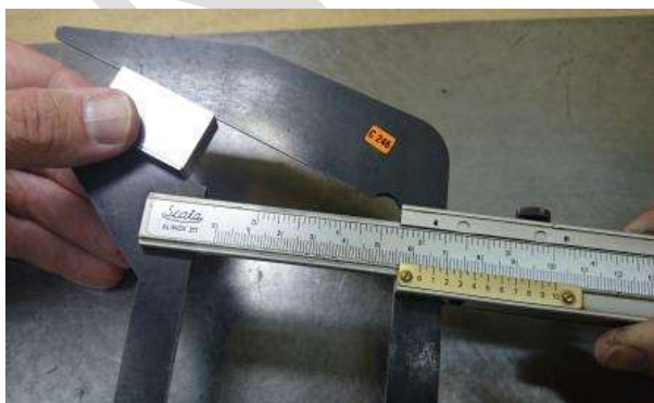
Obrázky č. 9 až č. 12 – Kalibrace pomocných ramen posuvného měřidla s tvarovým indexem
