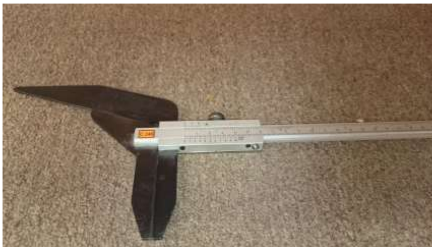
Obrázek č. 1 – Typ dvoučelistového posuvného měřítka s tvarovým indexem 1:3
