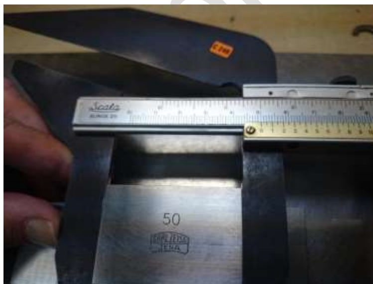
Obrázek č. 2 – Příklady použití dvoučelistového posuvného měřítka s indexem 1:3
