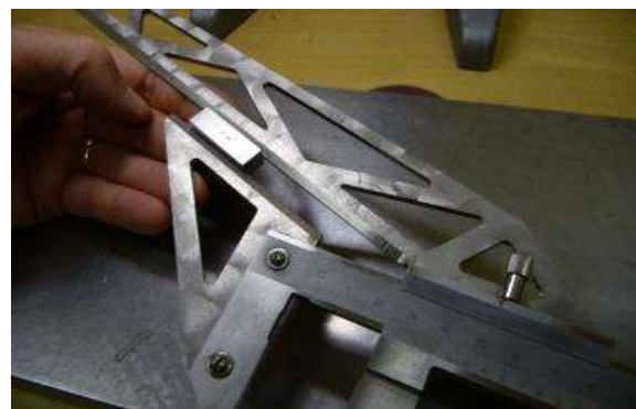
Obrázky č. 9 až č. 12 – Kalibrace pomocných ramen posuvného měřidla s tvarovým indexem
