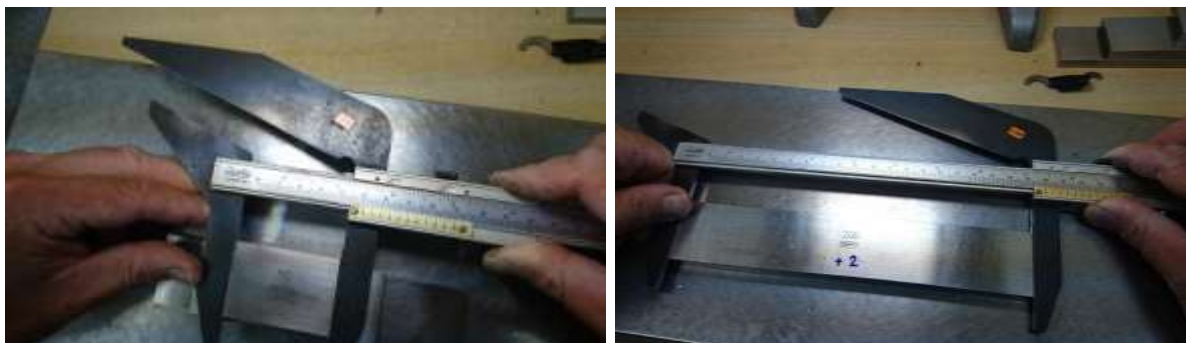
Obrázek č. 7 a č. 8 – Průběh kalibrace posuvného měřidla s indexem pomocí koncových měrek
