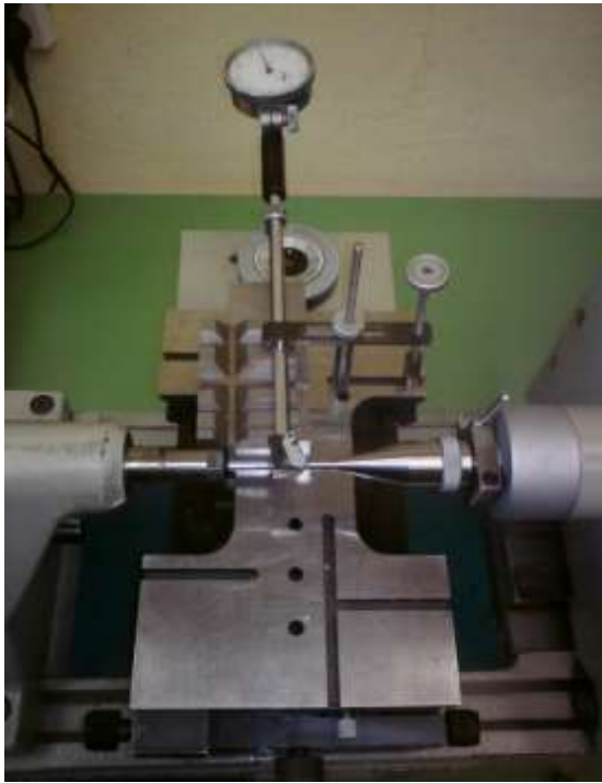
Obr. č. 1 Kalibrace dutinoměru na délkoměru
