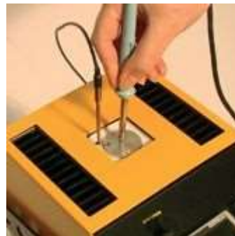
Obr. 2: Příklad použití dotykového homogenizačního bloku kalibrační pícky (ISOTECH)
