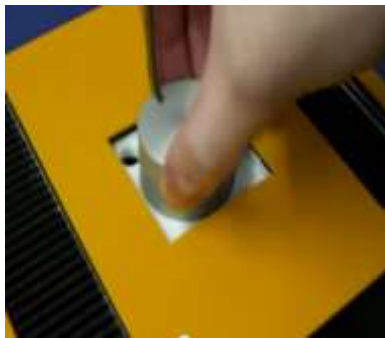
Obr. 2: Příklad použití dotykového homogenizačního bloku kalibrační pícky (ISOTECH)
