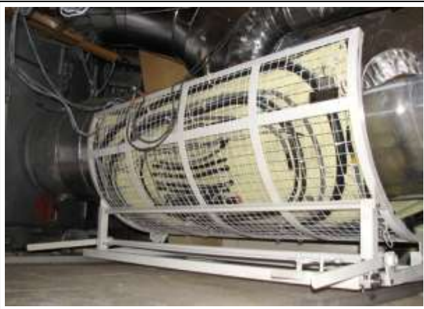
Svědečné kabely - vzorky, pro potřeby měření elektrických a mechanických vlastností.
