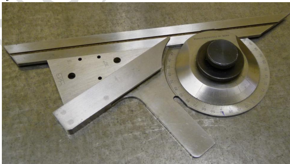
Kalibrace úhloměru pomocí úhlových měrek
