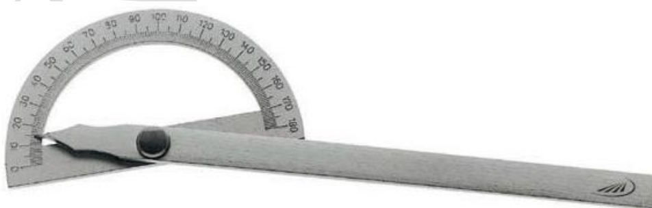
Obloukový úhломěr s otevřenou polokruhovou stupnicí (0°÷180°), odhad čtení ½ díku 0,5° (30')
