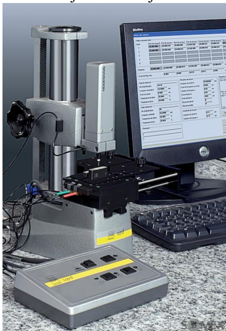
Obr. č.2 Komparátor měrek s univerzálním stojánkem a zvětšeným měřicím rozsahem
