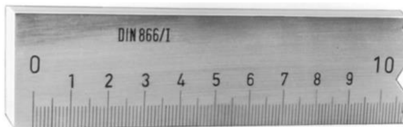
Obr. č. 3: Měřítko ploché s přesahem
