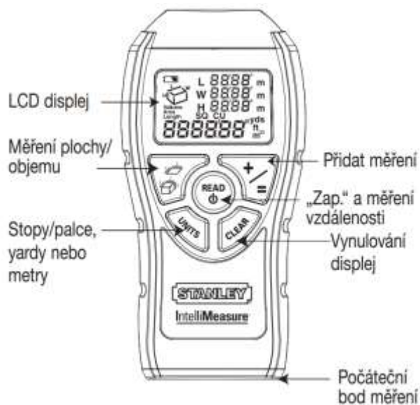
Obrázek č. 4: Popis ultrazvukového dálkoměru
