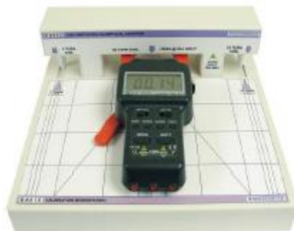
Obr. č. 13: Podložka k fixaci polohy kleští v cívice je velmi praktické a jednoduché opatření
