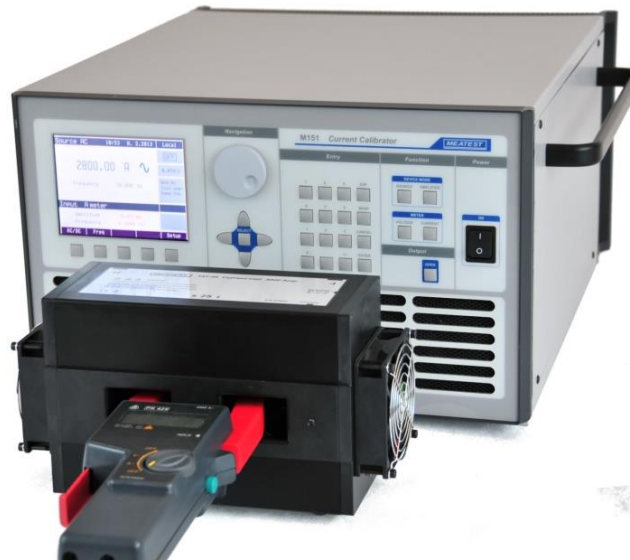
Obr. č. 16: Připojení cívky ke kalibrátoru (Meatest).
