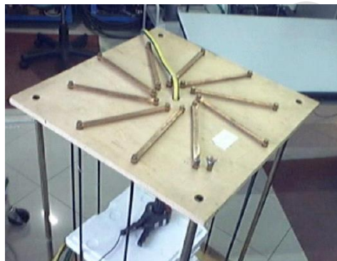
Obr. č. 9: Cívka se symetrickým polem (provedení podle AKL Firenze Tecnologia, Italie)
