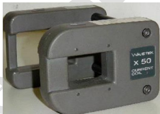
Obr. č. 17: Wavetek 9100. Jedná se o 2 cívky, 10 a 50 závitů. Cívky jsou stíněné a podle výrobce tím je potlačen vliv vodiče na opačné straně cívky a cívka se tak chová jako větší cívka bez stínění.
