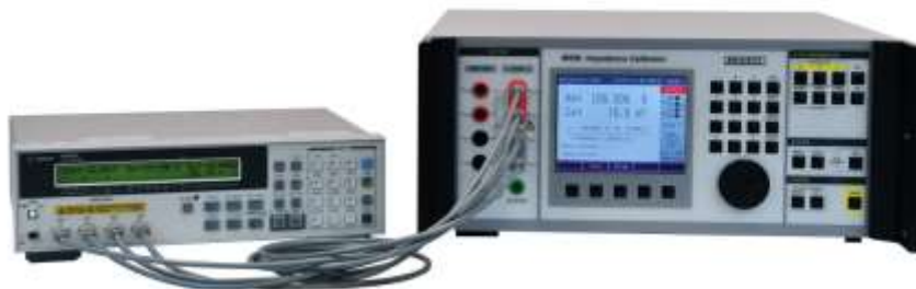
Obr. č. 7: Připojení RLC měřiče s čtyřpárovým připojením ke kalibrátoru M 550
