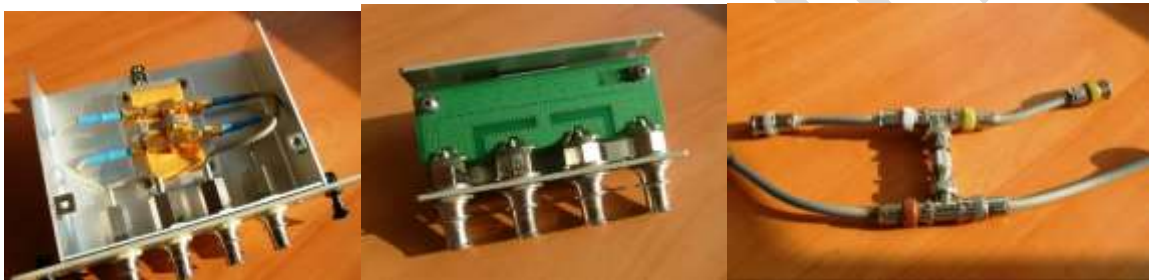
Obr. č. 3: Různá provedení zkratu (short)
