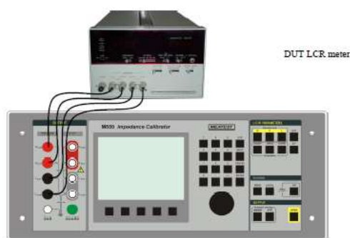
Obr. č. 8: Připojení RLC měřiče s čtyřsvorkovým připojením ke kalibrátoru M 550
