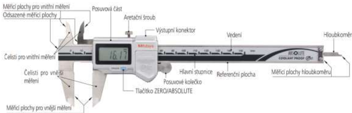
Obr. č. 2: Posuvné měřítko digitální:
