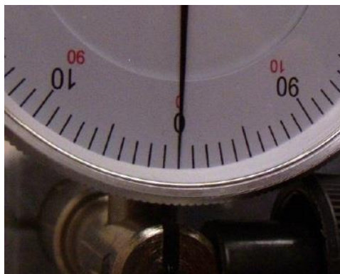
Chyba čtení měřené hodnoty způsobená paralaxou
